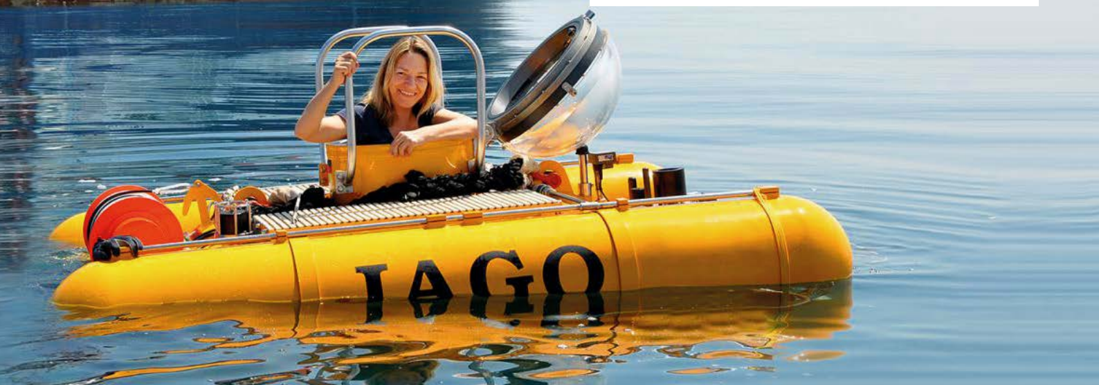
Das bemannte Unterwasserfahrzeug JAGO kann bis zu 400 Meter tief tauchen. Es wird zur Erkundung und Erforschung aquatischer Systeme und Lebensräume eingesetzt.
